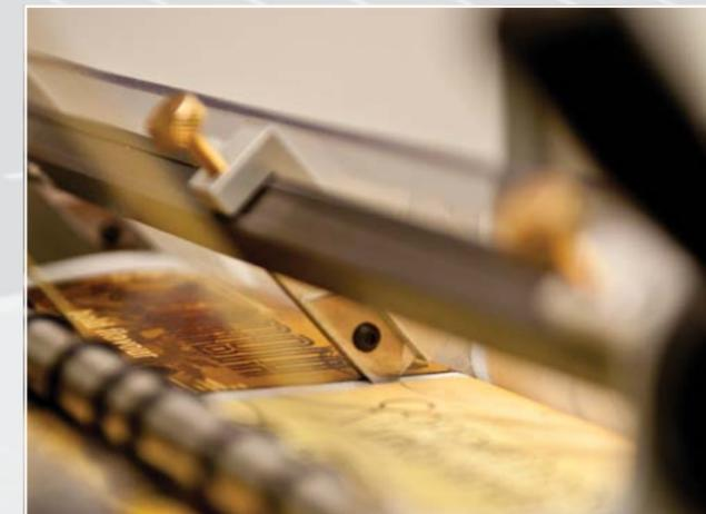
Rollenschneidemeser ermöglichen den Rollenschnitt in jeder Breite, mit bis zu 3 Klingen (Standard) und bis zu 5 Klingen als Option.
